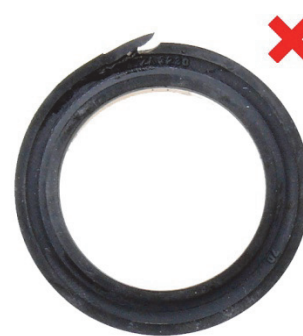
Rys. 7: Przycięta uszczelka wargowa (1)
