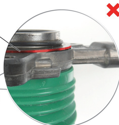
Rys. 3: Tuleja przesuwna wysunięta z uszczelnienia
