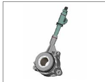
Fot. 2: Centralny wysprzęglik z odpowietrzeniem w przewodzie hydraulicznym
