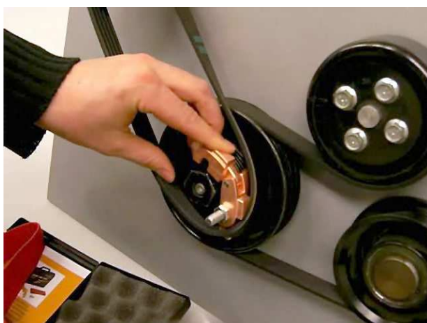
Umieścić narzędzie między kołem pasowym a paskiem mocno je przytrzymując.
