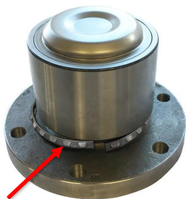
1. Zsunięty pierścień zabezpieczający.
