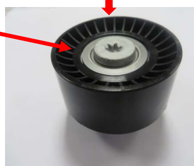
Jedna podkładka montowana od strony łba śruby
