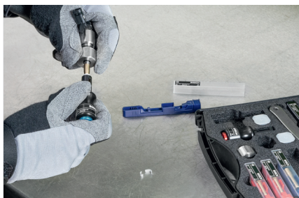
Nasowanie nowej uszczelki teflonowej
