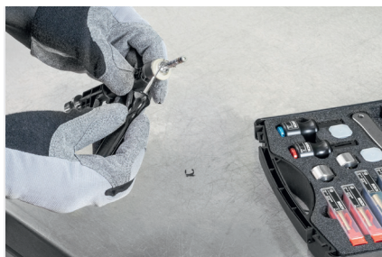
Demontaż elementu odsprężającego
