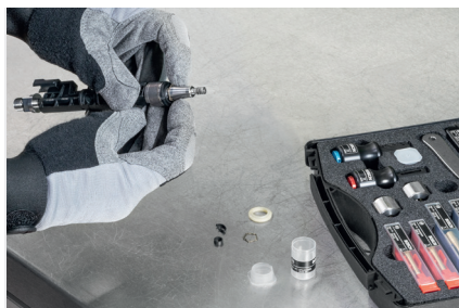
Montaż nowego elementu odsprężającego
