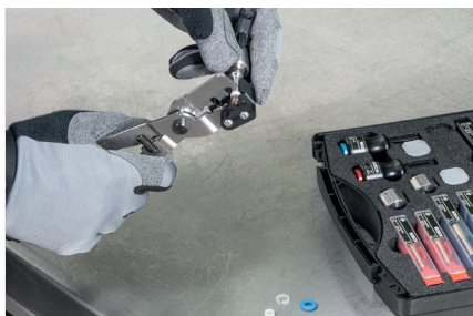
Demontaż uszczelki teflonowej (uszczelnienie od strony komory spalania)
